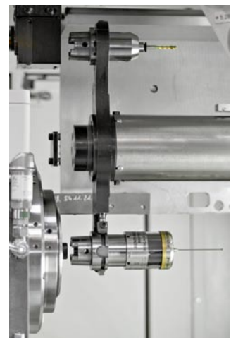
示例，52 个换刀工具库和仅通过一次装夹实现复杂工件的全面加工的转换过程。
