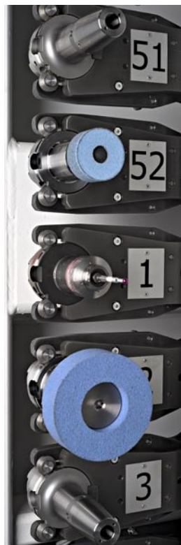
示例，52 个换刀工具库和仅通过一次装夹实现复杂工件的全面加工的转换过程。
