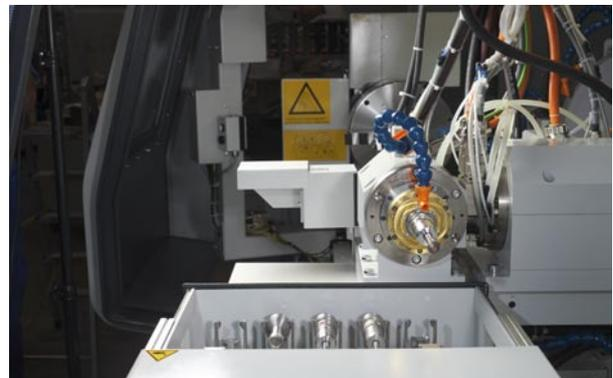
示例,集成在机器中的工具更换刀具等, 也可以进行加工和测量。
